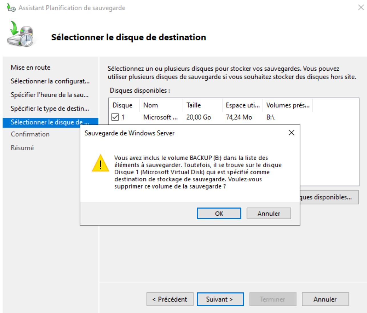
Suivre les étapes et terminer, une fois le système de sauvegarde en place, vous aurez sur la console un suivi des différentes tâche de sauvegarde et vous pourrez accéder aux différentes backup sur le disque de sauvegardes dans l'observateur d'évènement Windows.
